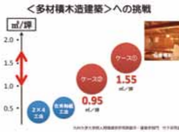
多材積木造建築ケース2: 響きの家 (2008年) ●材積 0.95㎡/坪 木造2階建て 敷地面積245.21㎡ 建築面積57.97㎡ 延床面積106.00㎡
